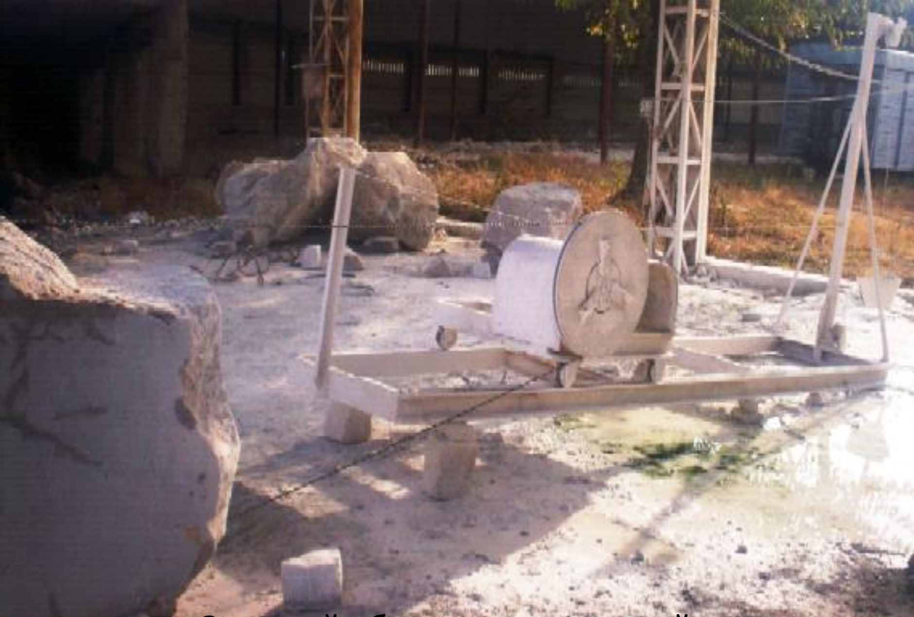
Опытный образец камнерезной машины КМК-1
